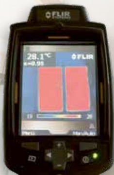
Aufnahme der Flächenheizung FH 300 PRO mit der Wärmebildkamera
