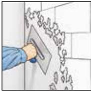
1.去除旧墙纸及涂料。粗糙不平的基面需用含石膏的填充物进行平整。吸收性特别强的基面需用不含溶剂的底胶打底。
