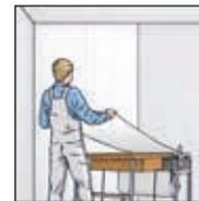
**2b.** nanos s tapecirnim strojem brez časa vpijanja. Za lepljenje uporabite lepilo za flis.
