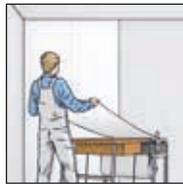
**4b.** Premazivanje tapeta ljepilom pomoću uređaja za premazivanje tapeta: staze provući kroz uređaj za premazivanje tapeta ljepilom te odrezati. Vodite računa da se uzorak jednolično ponavlja.
