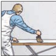
**4a.** Ručno premazivanje tapeta ljepilom: staze odrežite s dodatkom na visinu prostorije i pojedinačno ih premažite ljepilom za tapete. Vodite računa da se uzorak jednolično ponavlja ili
