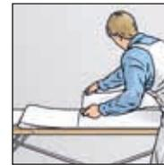
**5.** Staze premazane ljepilom za tapete preklopite u omjeru 2/3 prema 1/3. Preklope nemojte prelamati.
