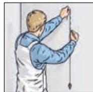
**2.** Der Untergrund muss trocken, sauber, fest, saugfähig und glatt sein. Breite der Bahn auf der Wand markieren und ausloten.
