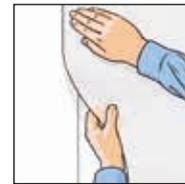
**4b.** bei überlappend gedruckten Tapetenbahnen die weißen Ränder im trockenen Zustand bis ans Motiv abschneiden. Dann die Bahnen an der Wand im Bereich der Überlappung aufeinander ausrichten. Zur sauberen Nahtbildung einen Doppelnahtschnitt durchführen.
