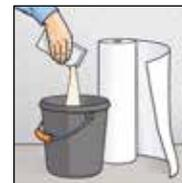
**3.** Zur Verklebung wird Vlieskleber verwendet.
