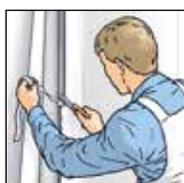
**9.** An Außenecken wird nicht überlappend tapetiert. Hier erfolgt die Trennung exakt auf der Kante.
