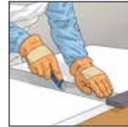
**3.** Laibungsplatte mit Cutter anritzen und über Kante brechen oder mit einer Säge zuschneiden.
