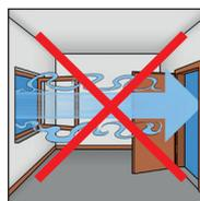
**7.** Während und nach dem Tapezieren kurz lüften, durch zu starkes Heizen und Zugluft kann es zu Nahtöffnungen kommen. Über Nacht Tür geöffnet und Fenster geschlossen lassen. **Durchzug vermeiden!**
