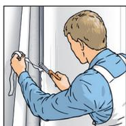
**6.** In Ecken und an Kanten nicht überlappend tapezieren, die Trennung erfolgt exakt auf der Kante und die nachfolgende Bahn auf Stoß tapezieren.
