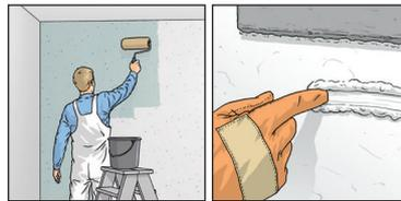
**2a.** Wir empfehlen: in Wandklebetechnik ohne Weichzeit verarbeiten. Kleister gleichmäßig und satt mit einer langflorigen Walze bahnenweise (siehe Fingertest) aufrollen.
