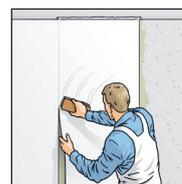
**5.** Наклеивать полотна вертикально по отвесу и в стык. Пузыри воздуха и складки разгладить с помощью обойной или резинового валика.
