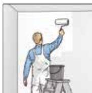
**2.** Основание должно быть чистым, сухим, прочным и обладать хорошей впитывающей способностью. Удалить непрочные покрытия.
