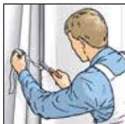
**5.** Излишки обоев на углах аккуратно обрезаются монтажным ножом или крючкообразным лезвием. Для стабилизации углов рекомендуется устанавливать пластмассовые уголки.
