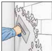
**1.** Удалить старые обои и покрытия. Неровные основания выровнять гипсо-содержащей шпаклевкой. Основания с высокой впитывающей способностью предварительно обработать грунтовкой, не содержащей растворителей.
