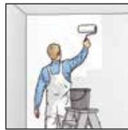
2. 基层墙面必须清洁、干燥以及有承载力和吸水性。无承载力的基层面应事先去除。
