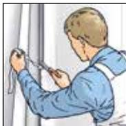
**4.** Überstehende Außenecken mit einem Cuttermesser oder einer Hakenklinge sauber abschneiden. Zur optischen Stabilisierung der Außenecken, empfiehlt sich das Anbringen von Kunststoffeckleisten auf das ERFURT-Variovlies Reno.
