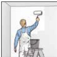
**1.** Der Untergrund muss sauber, trocken sowie trag- und saugfähig sein. Nicht tragfähige Untergründe vorher entfernen.
