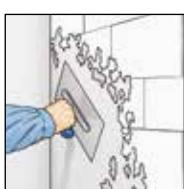
1. Odstraniti sve tapete i premaze. Hrapave podloge pomoću lopatice izravnajte masom za izravnavanje na bazi gipsa. Izrazito upijajuće podloge grundirajte sredstvom za grundiranje koje ne sadrži otapala.
