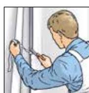
5. Višak u vanjskim kutovima odrezati čisto skalpelom ili kukastom britvom. Za optičku stabilizaciju vanjskih kutova preporuča se nanošenje plastičnih letvica na ERFURT-KlimaTec Thermovlies.
