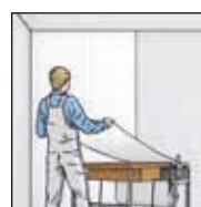
2b. U uređaju za premazivanje tapeta ljepilom bez omešavanja. Za lijepljenje koristite ljepilo na bazi flisa.
