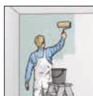
2a. Obrada tehnikom nanošenja ljepila na zid bez omešavanja ili.
