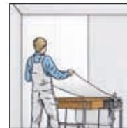
**2b.** Encollage à l'aide d'une colleuse sans détrempe. Pour l'encollage, utiliser de la colle à intissé.
