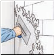
**1.** Odstraniti sve tapete i premaze. Hrapave podloge pomoću lopatice izravnajte masom za izravnavanje na bazi gipsa. Izrazito upijajuće podloge grundirajte sredstvom za grundiranje koje ne sadrži otapala.
